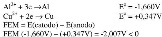
Logo, sendo a FEM  $< 0$ , a reação não é espontânea e a pilha não se forma. A corrosão dos tubos de cobre não ocorre nessa situação.
