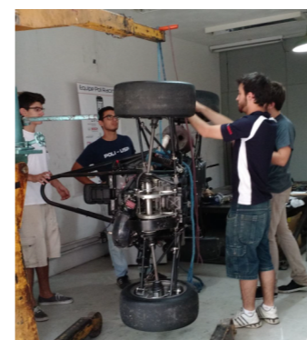
Suspensão - medições de CG, inércia e o sensoriamento do carro.
