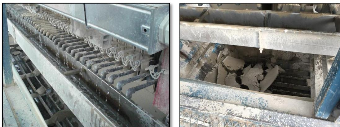
**Fotos 12 e 13:** Detalhes do filtro prensa e do rejeito gerado após processamento por espessamento e filtragem na empresa Pedrix Ltda. (*drystack*).
