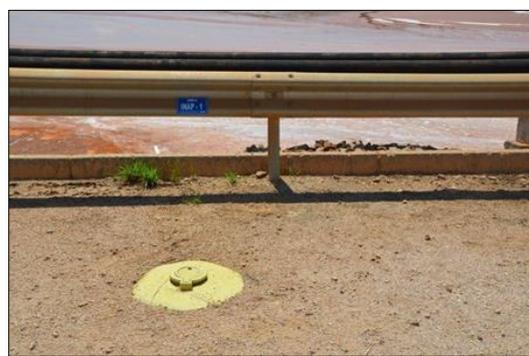
**Fotos 25 a 26:** À esquerda, Piezômetro Casagrande e à direita, indicador de nível d'água (INA).
