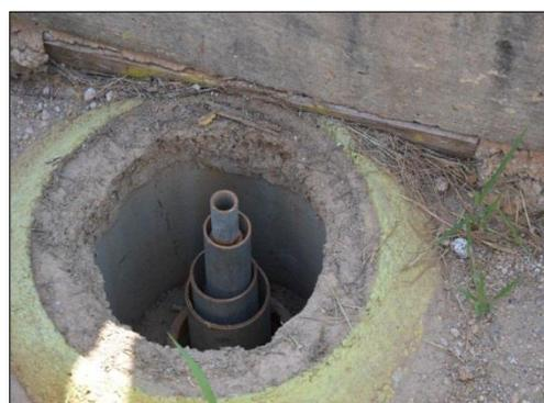
**Foto 27 e Foto 28:** À esquerda, medidor eletrônico de deslocamento e, à direita, medidor de recalque telescópico IPT para medição de deslocamentos verticais em cotas diferentes.
