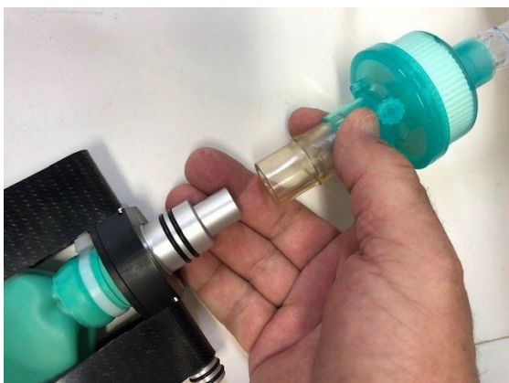
Figura 44 - Posicionando filtro HME para conectar ao acesso ao paciente.
