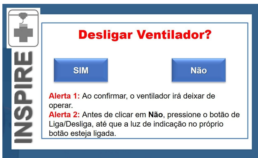
Figura 15 - Tela de confirmação de desligamento do INSPIRE
