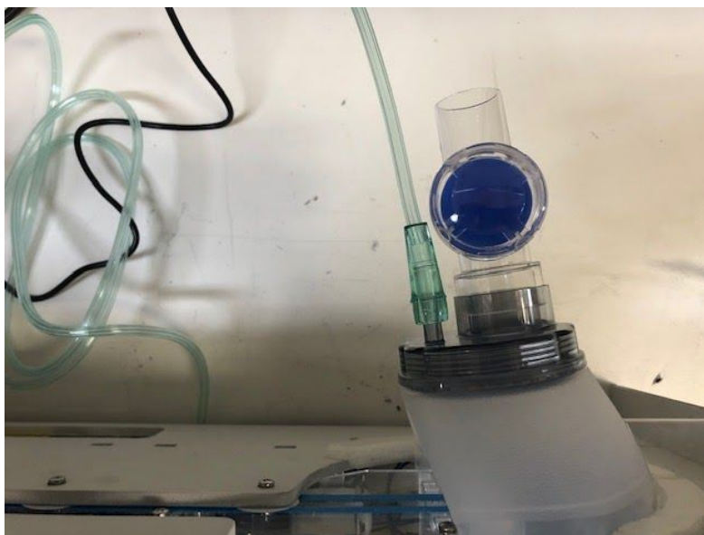
Figura 19 - Linha de oxigênio e válvula de entrada conectada ao INSPIRE.
