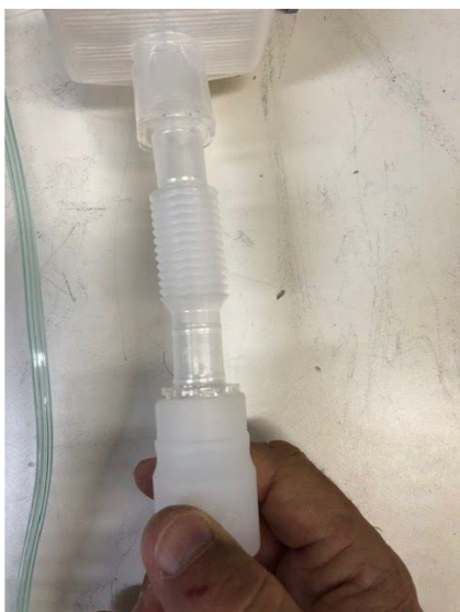
Figura 34 - Rotacionando no sentido horário para desconectar circuito de expiração do filtro HEPA.
