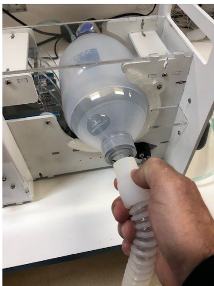
Figura 22 - Desconectar circuito inspiratório.
