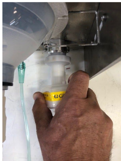
Figura 39 - Rotacionando no sentido anti-horário até ter boa fixação.
