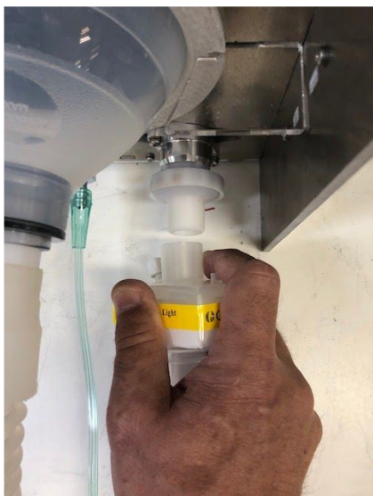
Figura 38 - Conectando filtro HEPA à válvula PEEP
