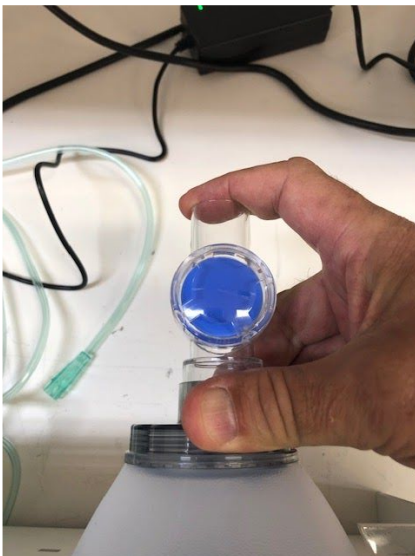
Figura 28 - Reconectar válvula de entrada.
