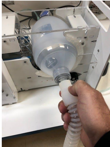
Figura 30 - Reconectar circuito de inspiração.
