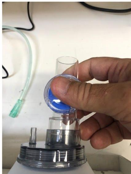
**Figura 24** - Desconectar válvula de entrada.
