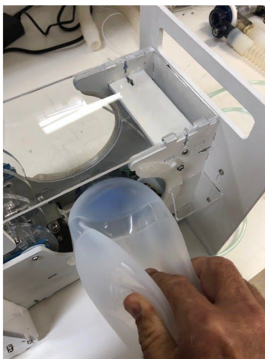
Figura 26 - Como deformar o AMBU para encaixá-lo no INSPIRE.
