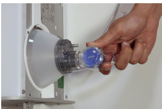
Figura 28 - Reconectar válvula de entrada.
