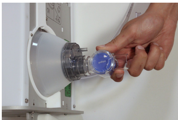
Figura 24 - Desconectar válvula de entrada.
