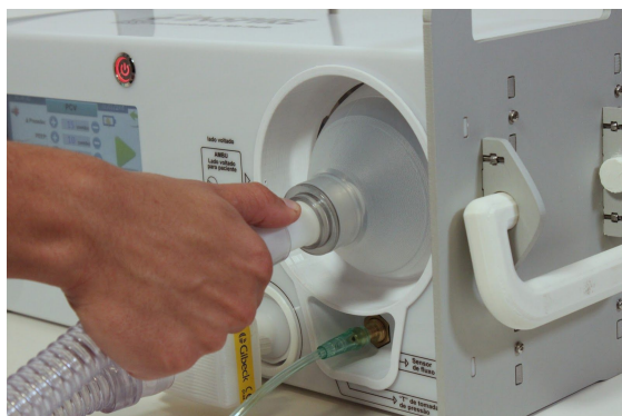
Figura 22 - Desconectar circuito inspiratório.
