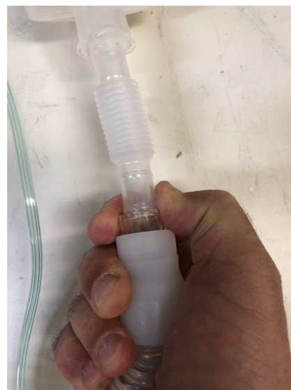
Figura 35 - Desconectando circuito de expiração do filtro HEPA.
