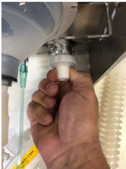
Figura 33 - Verificando peça de conexão da válvula PEEP.
