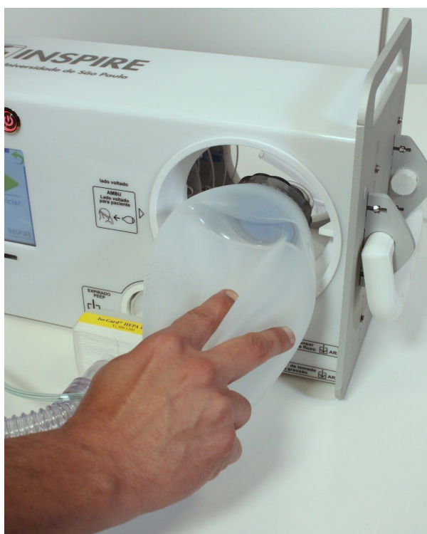
Figura 26 - Como deformar o AMBU para encaixá-lo no INSPIRE.
