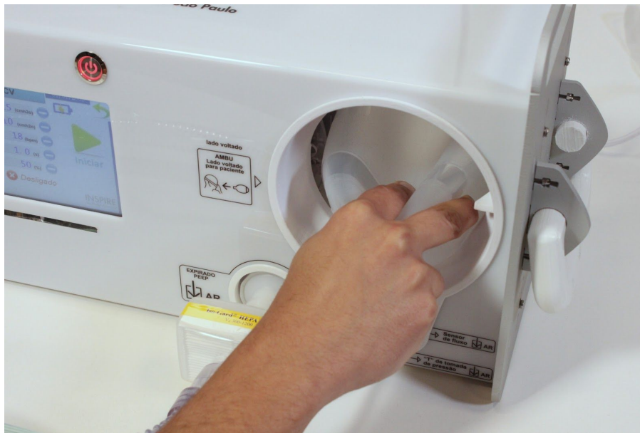
Figura 25 - Como deformar o AMBU para retirá-lo do INSPIRE.
