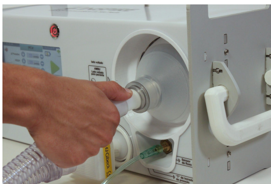
Figura 30 - Reconectar circuito de inspiração.
