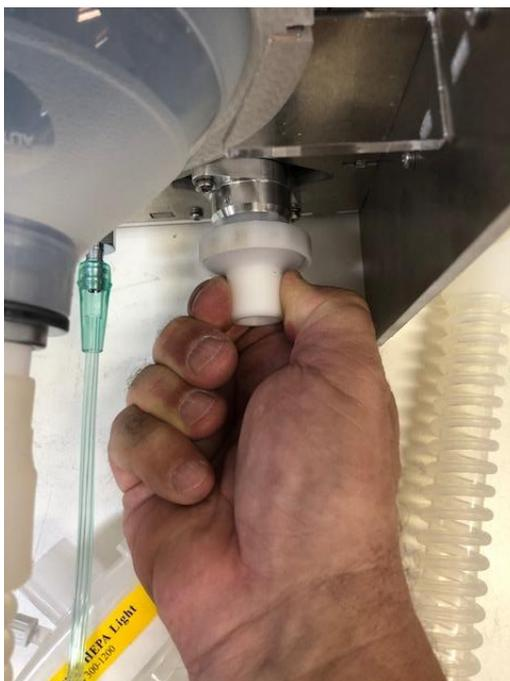
**Figura 33** - Verificando peça de conexão da válvula PEEP.
