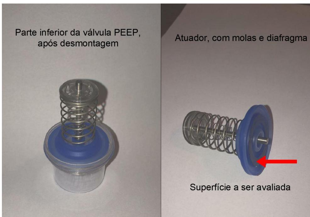
**Figura 49** - Atuador interno da válvula PEEP
