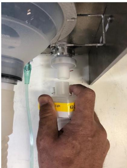
**Figura 38** - Conectando filtro HEPA à válvula PEEP
