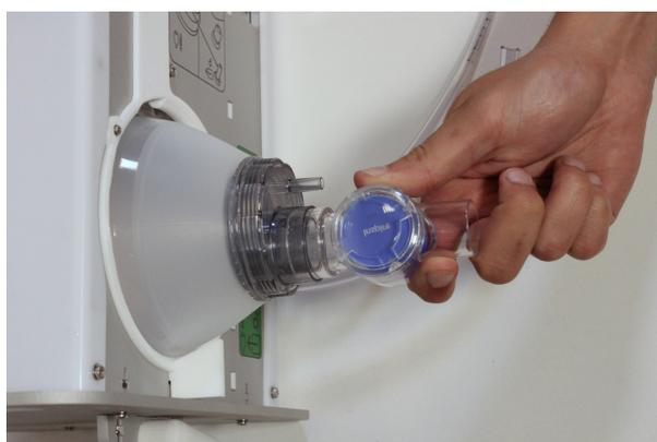
**Figura 24** - Desconectar válvula de entrada.
