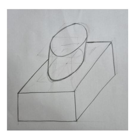
**5)** Desenhar a perspectiva **isométrica** da peça dada abaixo por suas vistas, representadas no primeiro diedro em escala natural. Posicionar a peça na grade isométrica mostrando suas faces superior, frontal e lateral direita.
